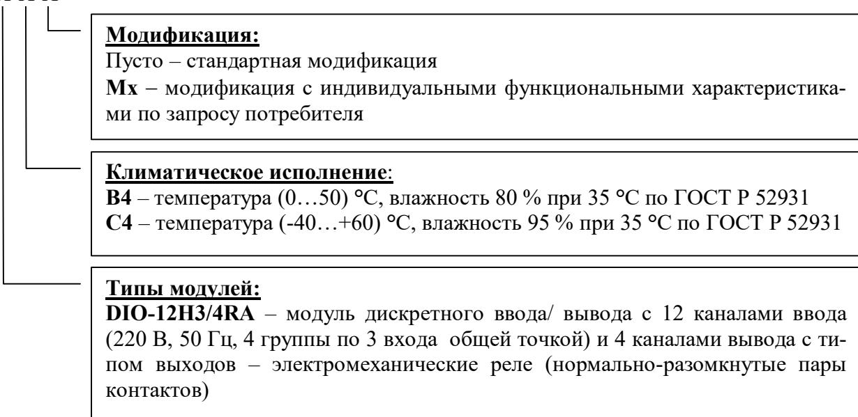
**Пример обозначения при заказе:** Модуль **MDS DIO-12H3/4RA-C4** – модуль дискретного ввода/вывода с 12 каналами ввода (220 В, 50 Гц, 4 Группы по 3 входа общей точкой) и 4 каналами вывода с типом выходов – электромеханические реле (нормально-разомкнутые пары контактов), группа климатического исполнения - C4, стандартная модификация.
