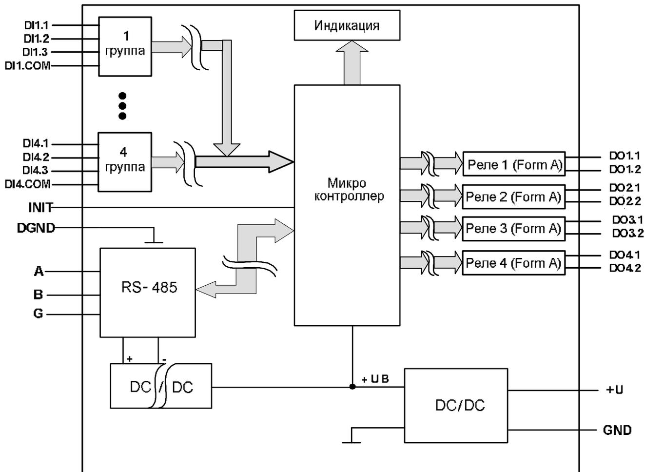
Рисунок 4.2 – Функциональная схема модуля MDS DIO-12H3/4RA
