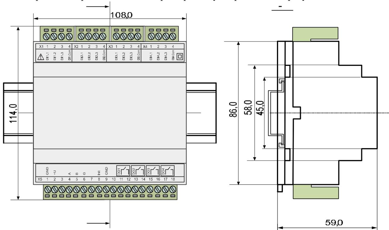
Рисунок 5.1 – Габаритные и присоединительные размеры модуля
