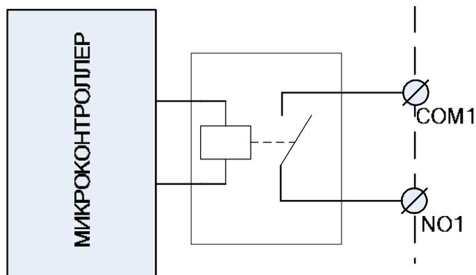
Рисунок 5.4 – Первый релейный канал вывода дискретного сигнала
