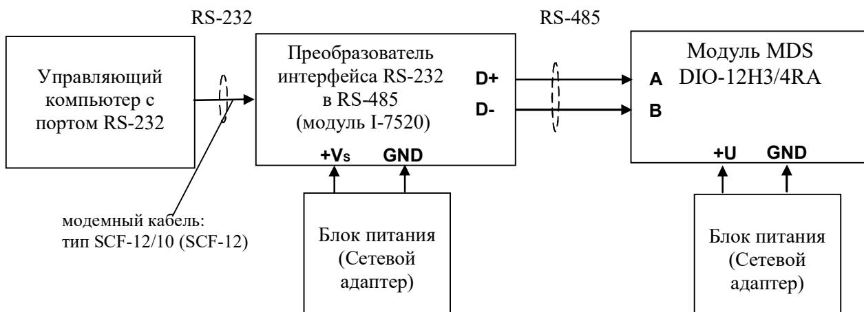
Рисунок 6.1 – Схема подключения модуля для режима работы
