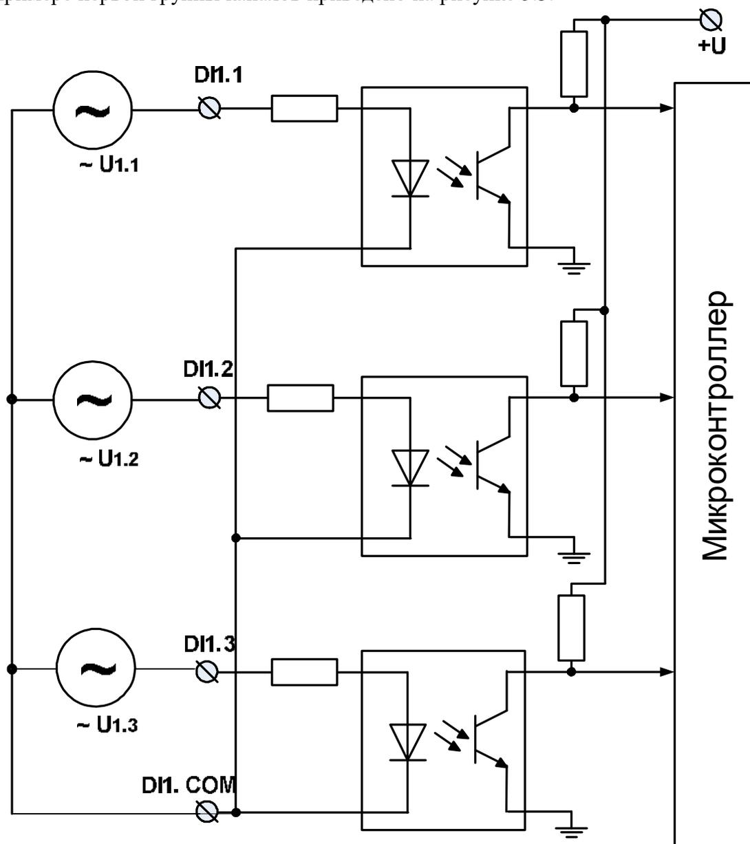
Рисунок 5.3 – Подключение к модулю сигналов напряжения переменного тока
